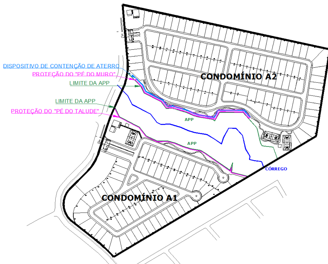
Figura 5.3 Indicação do muro de contenção de aterro tipo Terramesh® Grid e proteção do “pé do muro” no Condomínio A2 e proteção do “pé do talude” de aterro do Condomínio A1.
