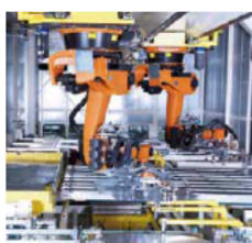
1 – Desempilhador de chapas robotizado
