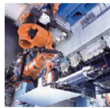
3 – Movimentação de peças por robôs tipo crossbar;
