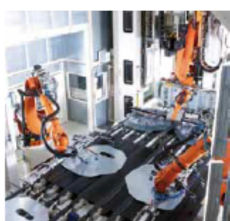
2 – Estação de posicionamento óptico
