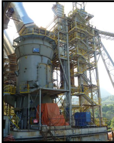
Figura 4 - Visão Geral de Moagem de Crú Vertical Fonte: Arquivos Votorantim
