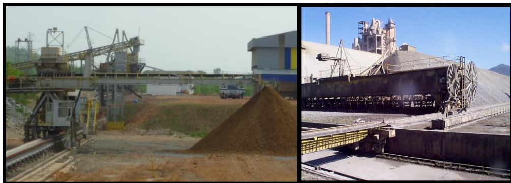
Figura 3 - Homogeneização de Matéria- Prima Calcário Fonte: Arquivos Votorantim
