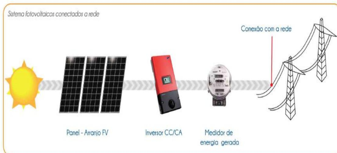
Figura 4: Ilustração do processo de transformação da energia solar em elétrica.
