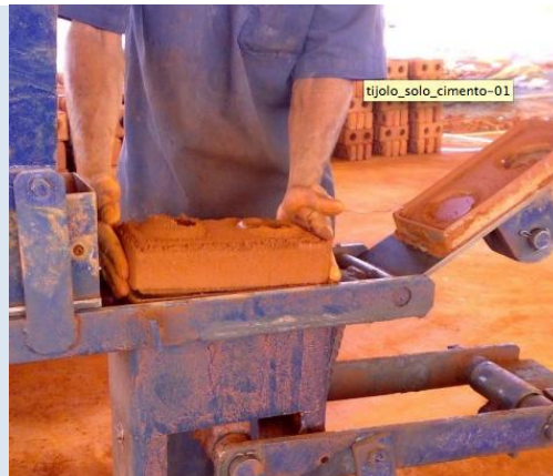
Figura 6 – Fabricação do tijolo de solo-cimento
