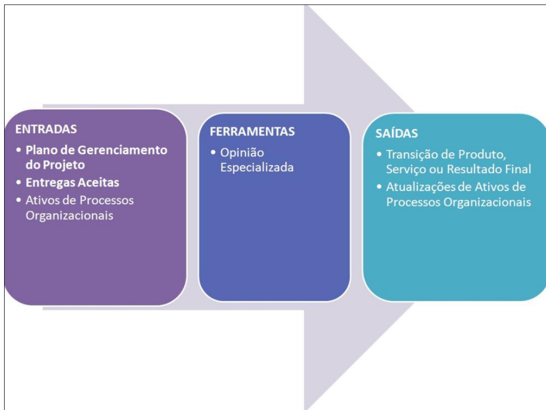
Figura 12: Entradas, ferramentas e saídas do processo Encerrar o Projeto ou Fase
