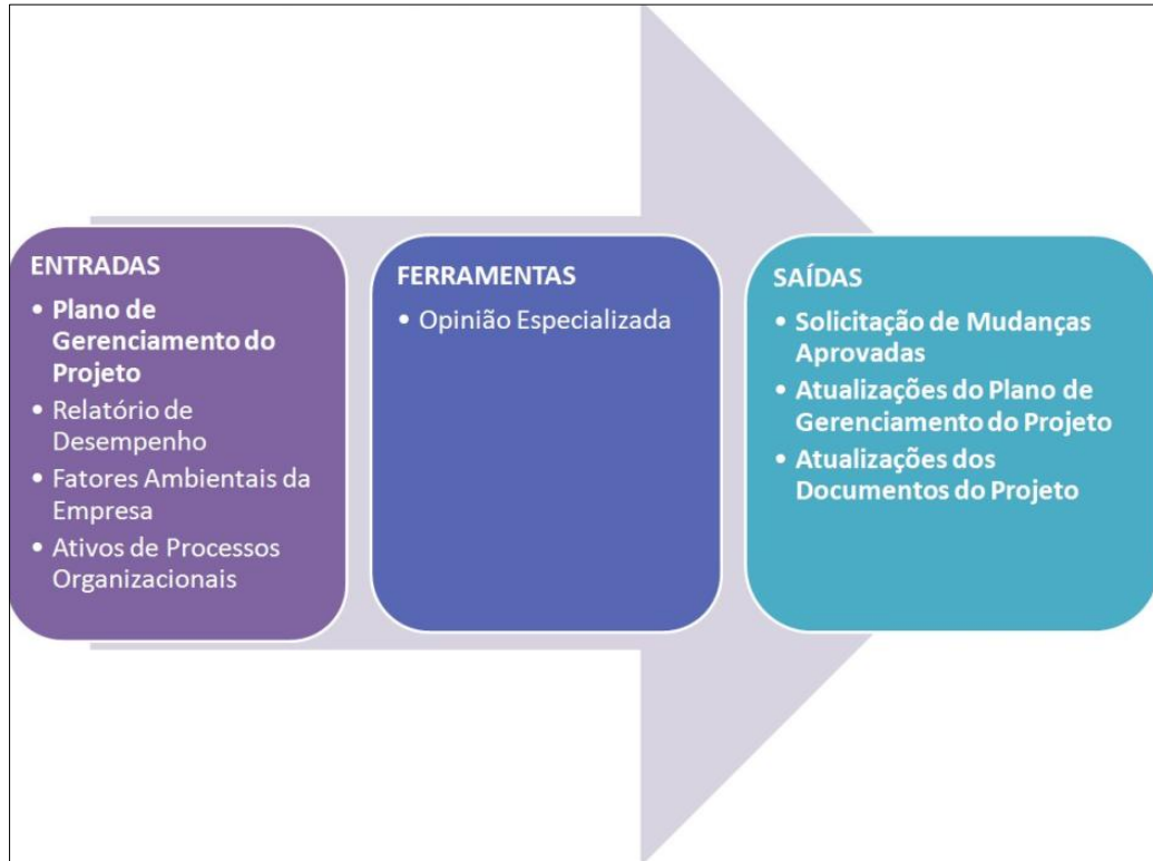
Figura 10: Entradas, ferramentas e saídas do processo Monitorar e Controlar o Trabalho do Projeto
