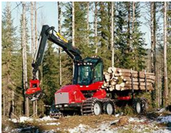
Figura 5: 1º Maq. Combi ( Harvester - Trator Florestal)
