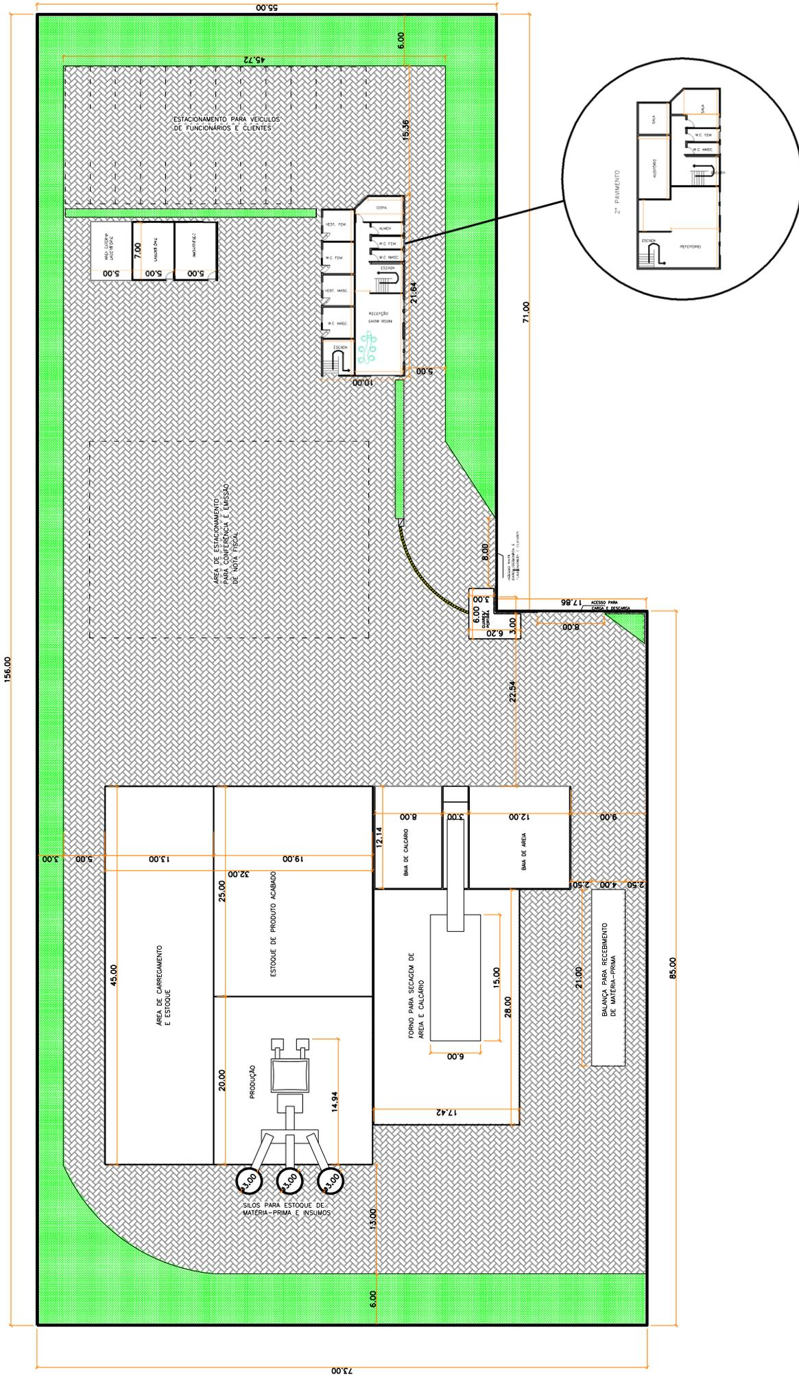
Figura 08 – Layout das futuras instalações da Inova Argamassas.
