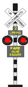
FIGURA 3 – ILUSTRAÇÃO DO EQUIPAMENTO DE PROTEÇÃO DO TIPO 3C (COM CAMPAINHA) – FONTE: NBR 15942 (ABNT, 2011)
