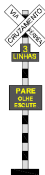
FIGURA 2 – ILUSTRAÇÃO DO EQUIPAMENTO DE PROTEÇÃO DO TIPO 1 COM POSTE DE TUBO – FONTE: NBR 15942 (ABNT, 2011)
