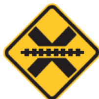
FIGURA 4 – ILUSTRAÇÃO DA PLACA A-39 – PASSAGEM EM NÍVEL SEM BARREIRA – FONTE: MANUAL BRASILEIRO DE SINALIZAÇÃO DE TRÂNSITO. VOL. II – SINALIZAÇÃO VERTICAL DE ADVERTÊNCIA (DENATRAN, 2007)
