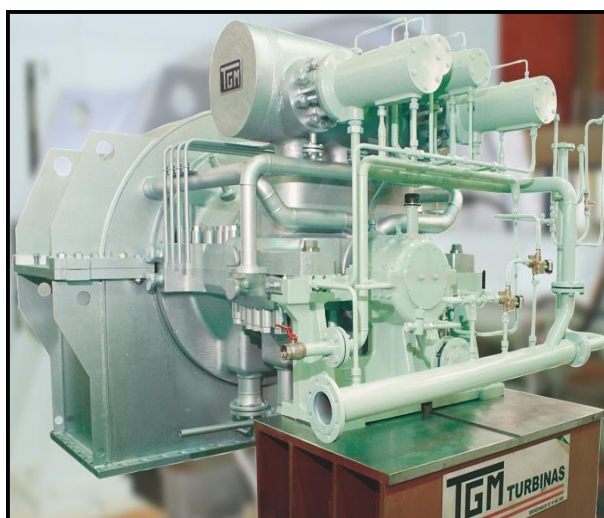
Figura 7. Turbina de condensação.
