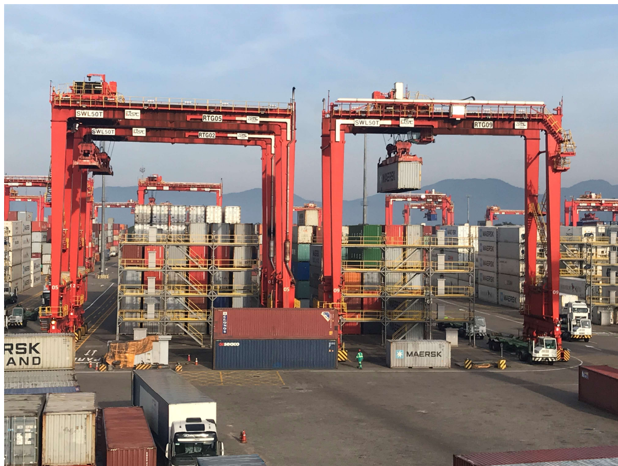
FIGURA 03 – Imagem do equipamento RTG em operação
