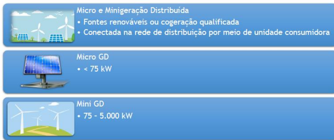
Figura 11 - Definição Micro e Minigeração distribuída
