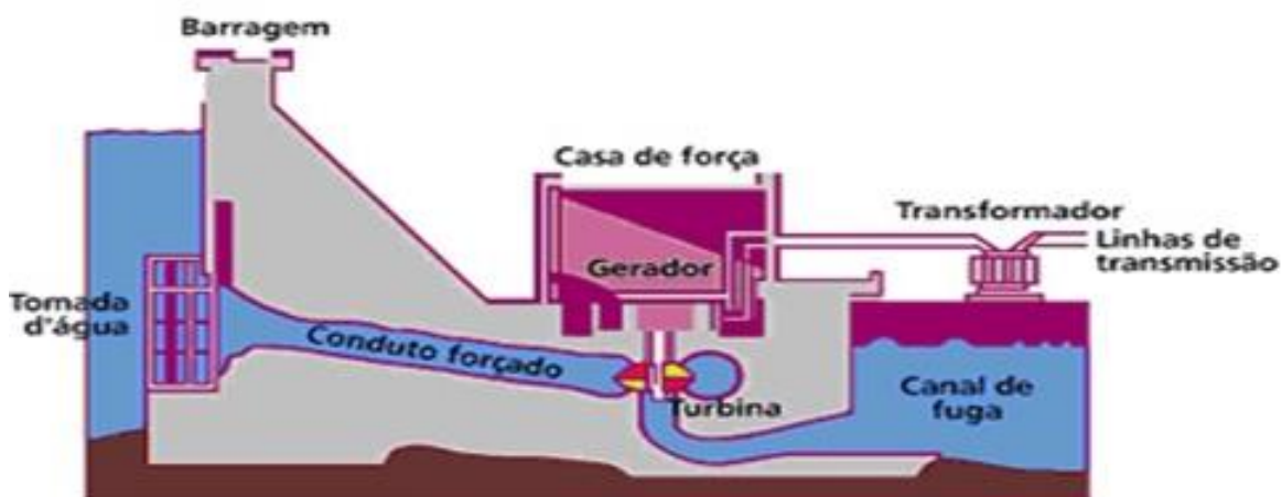
Figura 2 - Estrutura da CGH Fonte: Hidroenergia 2018
