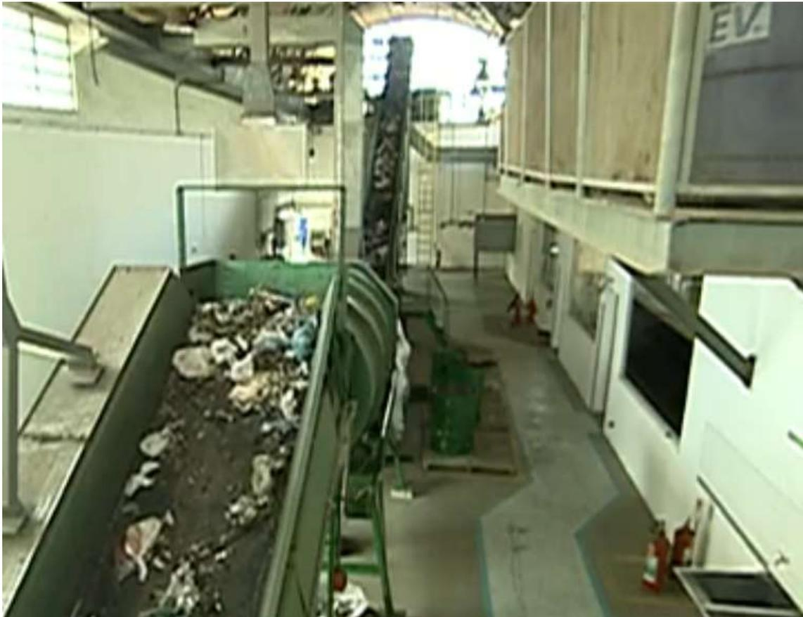
Figura 18 – Esteira Alimentadora dos RSU
