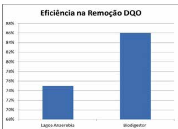
Figura 6 – Eficiência na remoção de DQO comparando a lagoa anaeróbia (2011) com o biodigestor (2012)
